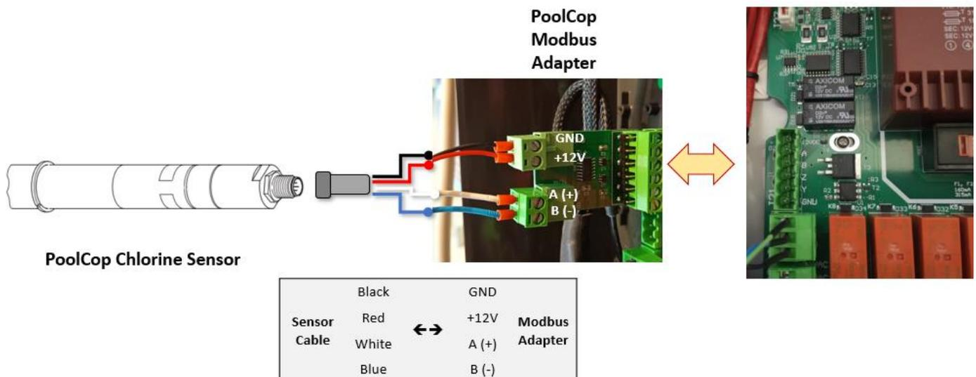
Figure 8 – Raccordement du câble de communication
