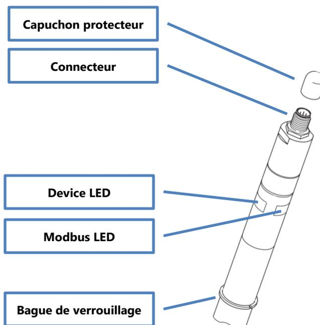
Figure 10 – Connecteur de la sonde de chlore, LED's
