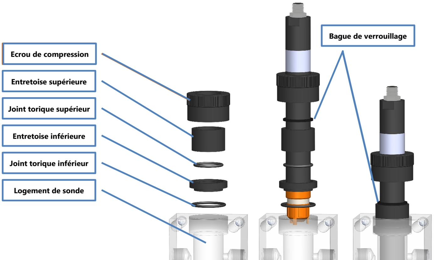
Figure 5 – Raccords de compression de la sonde
