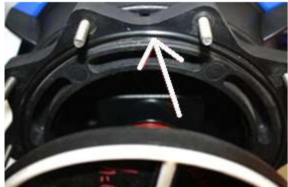
Figura 8 - Junta tórica válvula 2,0"
