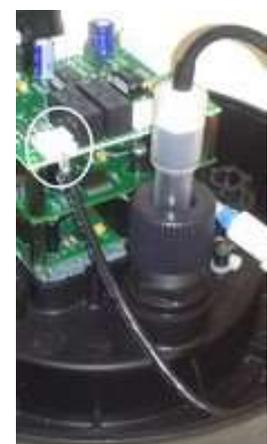
Figura 48 - Conexión de la sonda
