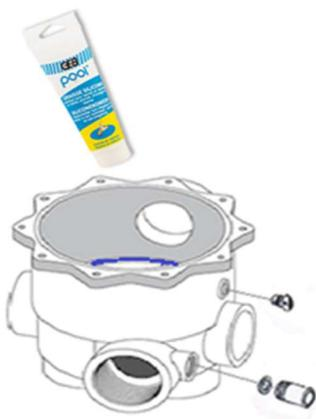
Figura 9 – Lubricación de la junta y la válvula
