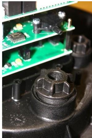
Figure 47 - Bouchon de la chambre d'analyse
