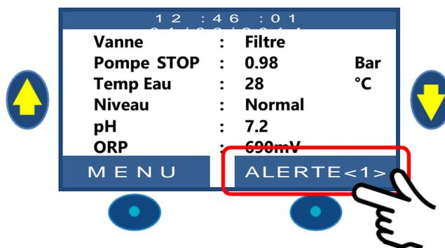
Dans le cas d'alertes multiples, les touches **HAUT** et **BAS** permettent de faire défiler les messages d'alerte.
