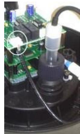
Figure 48 - Connexion de la sonde
