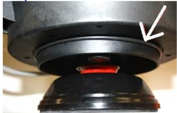
Figure 7 - Joint torique vanne 1.5"
