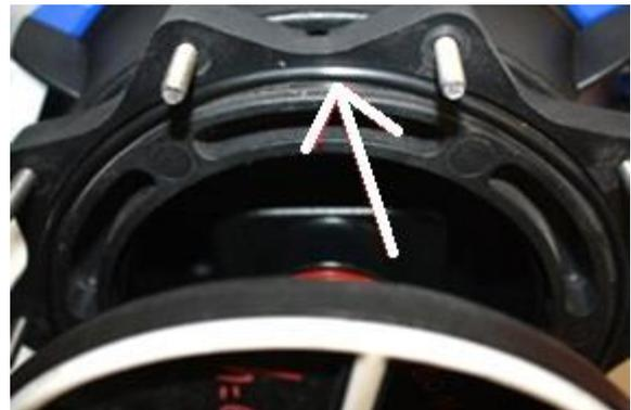
Figure 8 - Joint torique vanne 2.0"
