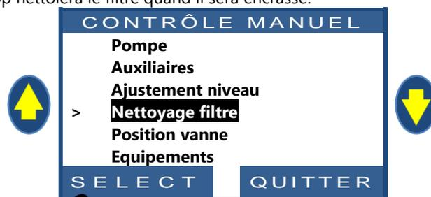
PoolCOP contrôle désormais automatiquement la pompe et le filtre pour effectuer un lavage et un rinçage, en fonction des paramètres programmés. L'écran affichera l'évolution du cycle et les pressions, pendant le nettoyage du filtre. Une fois le cycle terminé, le système revient à un fonctionnement normal.
