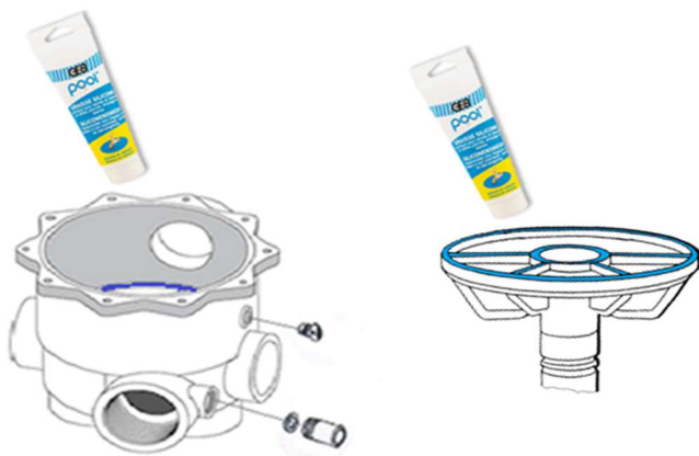
Figura 9 - Ingrassaggio delle guarnizione valvola ed il corpo valvola
