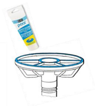
Afbeelding 9 - Smering van de afdichting en de klep
