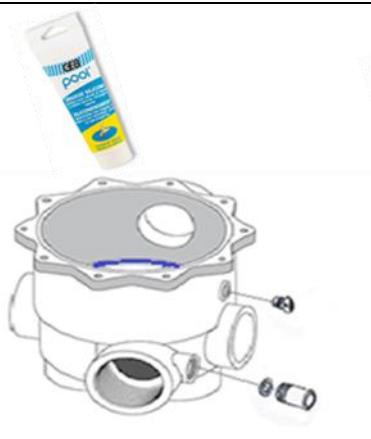
Afbeelding 9 - Smering van de afdichting en de klep
