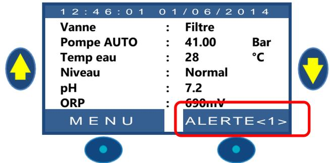
Dans le cas d'alertes multiples, les touches **HAUT** et **BAS** permettent de faire défiler les messages d'alerte.
