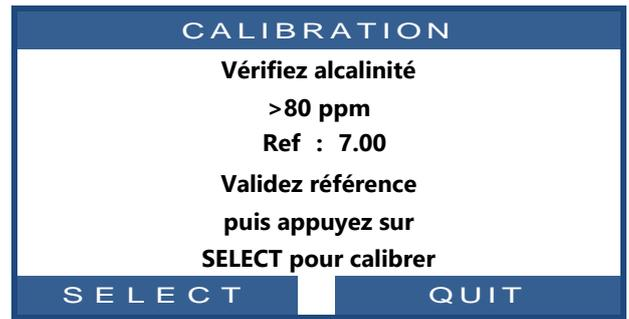
Réalise la calibration de la sonde de pH.
