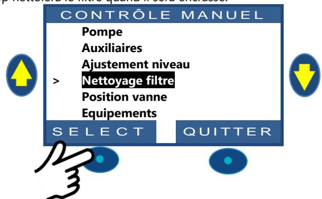
PoolCOP contrôle désormais automatiquement la pompe et le filtre pour effectuer un lavage en fonction des paramètres programmés. L'écran affichera l'évolution du cycle et les pressions, pendant le nettoyage du filtre. Une fois le cycle terminé, le système revient à un fonctionnement normal.
