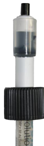
Afbeelding 51 - Aansluiting van de sonde SO4913
