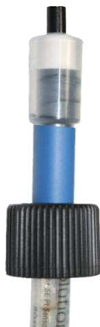
Afbeelding 50 - Aansluiting van de sonde SO4912
