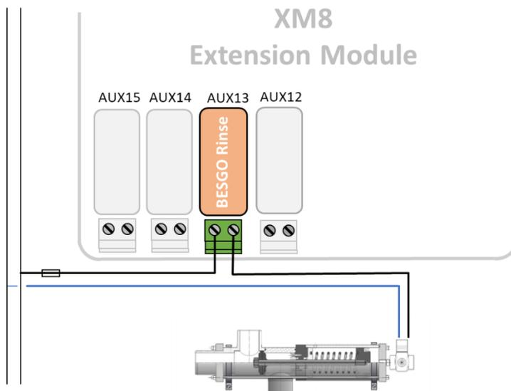
Figura 63 - Conexão BESGO para enxaguar em 230VAC
