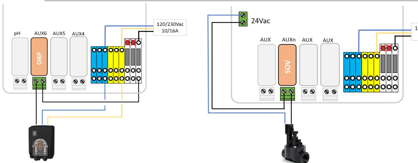
**Figura 54 – Ligação para bomba doseadora de 230Vac ou válvula solenoide de 24Vac para desinfecção**
