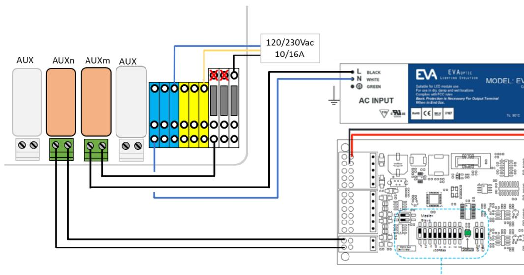
Figura 81 - Ligação uma luz conduzida Eva Optic
