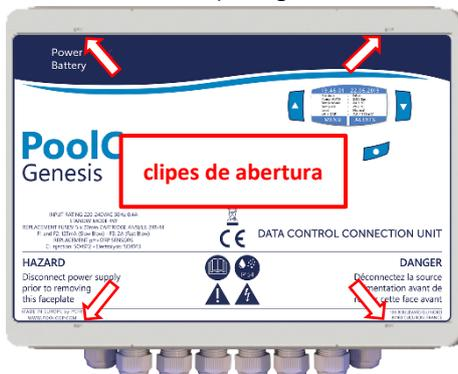
Figura 4 - Abertura da caixa e entrada do cabo
