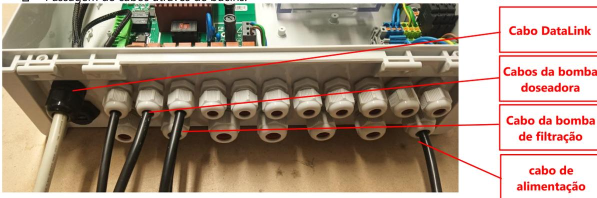
Figura 6 – Passagem de cabos através de buçins.
