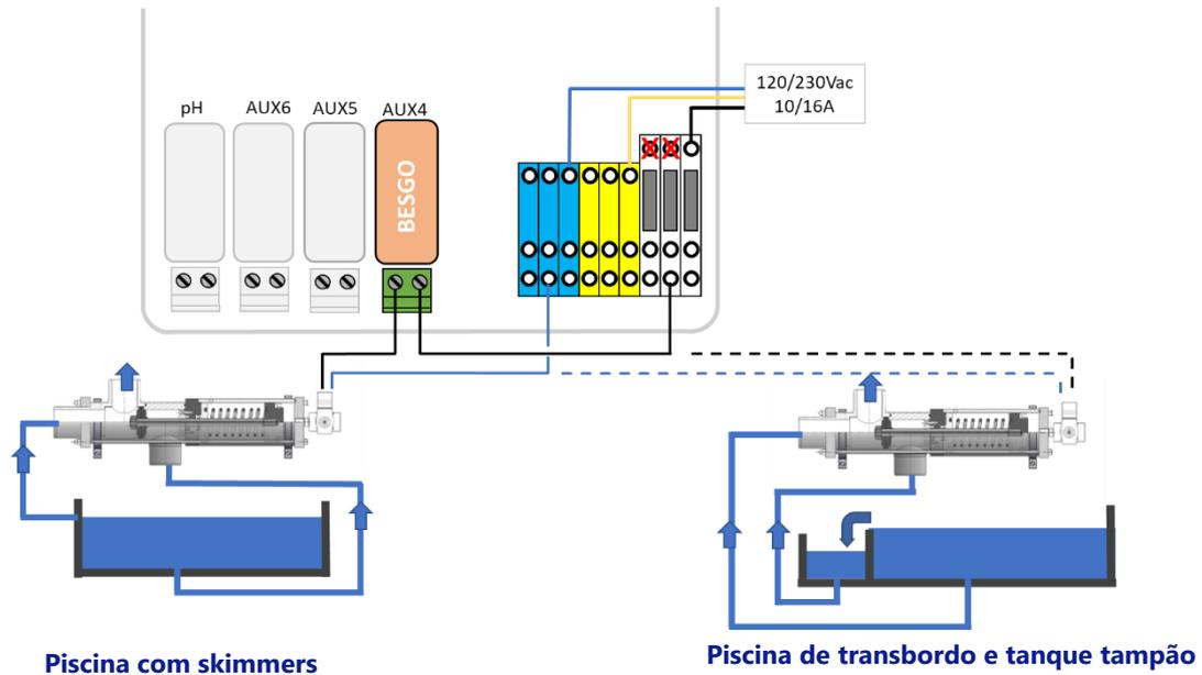
Figura 64 - Conexão de uma válvula de sucção de 3 vias BESGO em 230VAC
