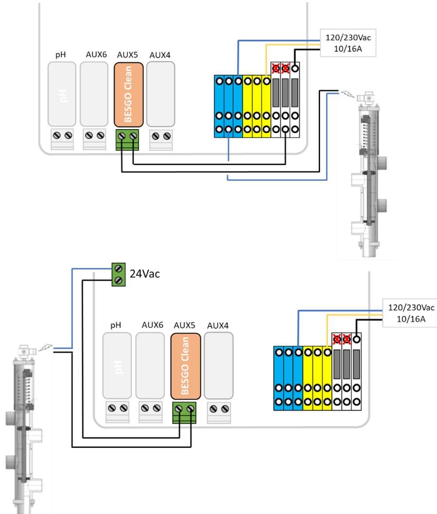
Figura 62 - Conexão BESGO em 230VAC (esquerda) ou em 24VAC (direita)
