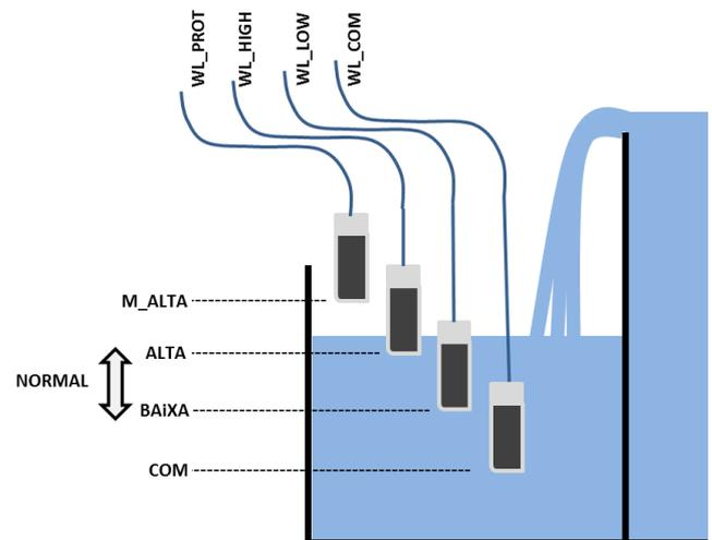
Figura 57 - Sensores de nível do tanque regulador
