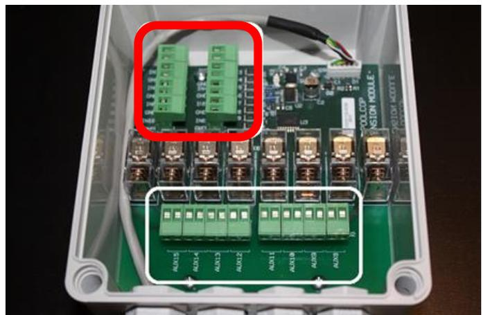
Figura 40 - Conexão de entradas no módulo de extensão XM8
