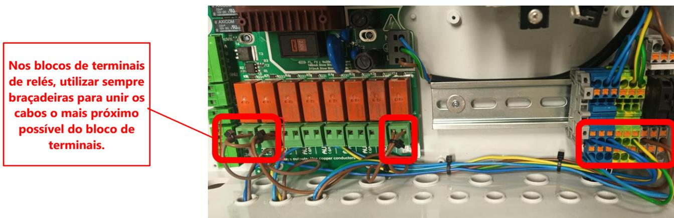
Figura 8 – Utilizar o bloco de terminais
