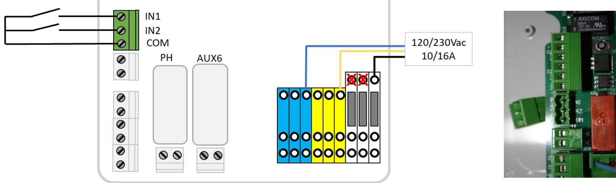
Figura 39 - Conexão de entradas na DCCU
