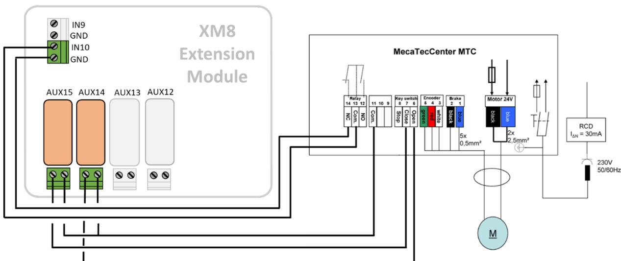
Figura 69 - Exemplo de conexão com a cobertura do MecaTecCenter
