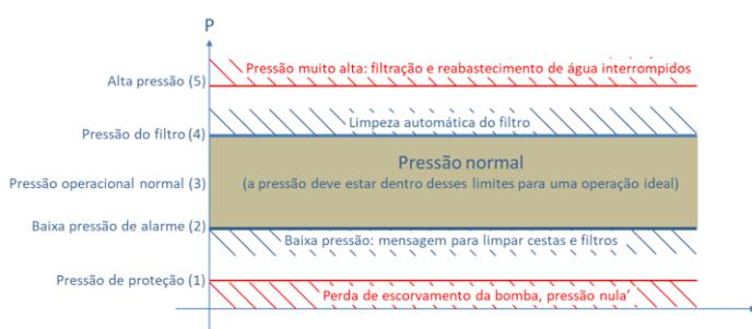
Figura 83 - Parâmetros de ajuste de pressão
