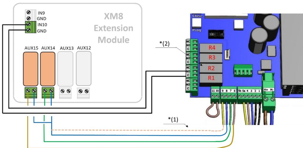
Figura 71 - Exemplo de conexão com a cobertura do Swim Safe
