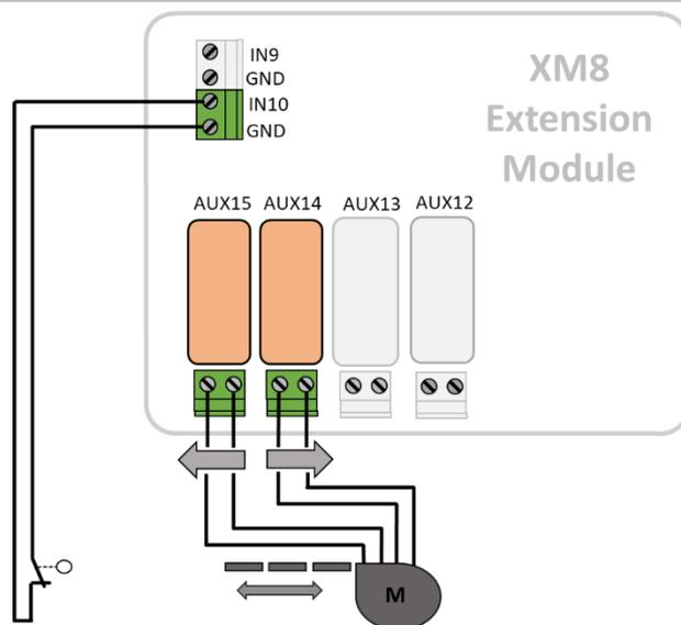
Figura 68 - Conexão da cobertura da piscina (controle e posição)
