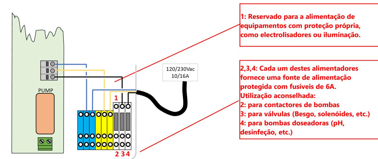
Figura 7 – Utilizar o bloco de terminais
