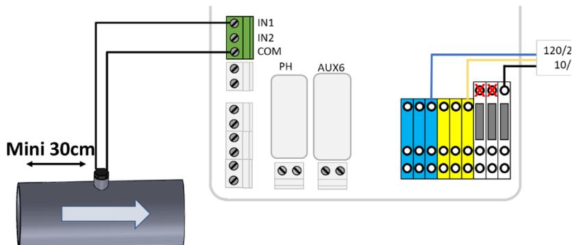
Figura 76 - Conexão do fluxostato a uma entrada
