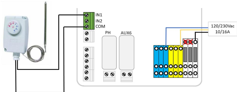
Figura 42 - Ligações de Termóstato Externo
