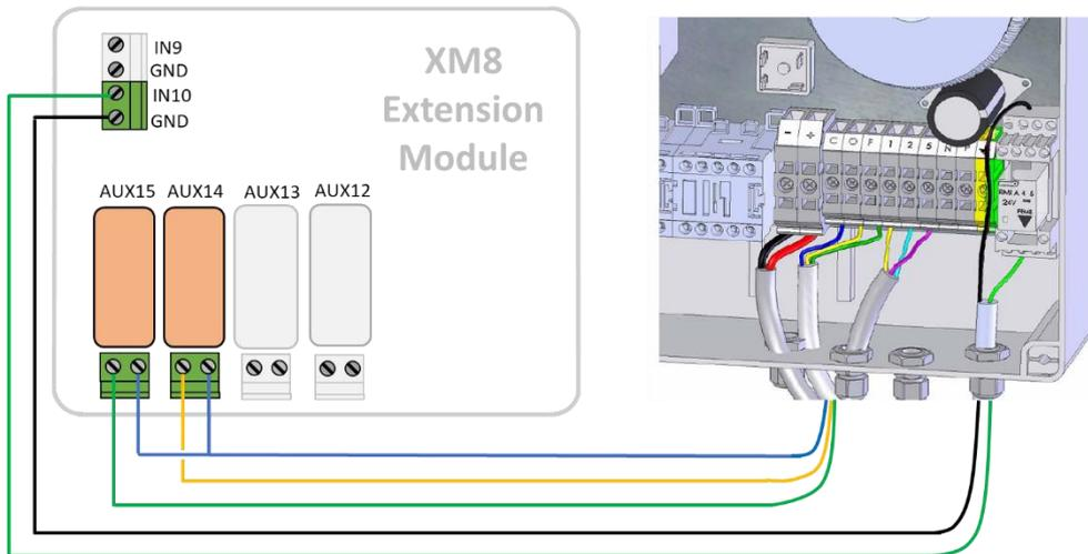
Figura 70 - Exemplo de conexão com a cobertura do Astral Roussillon
