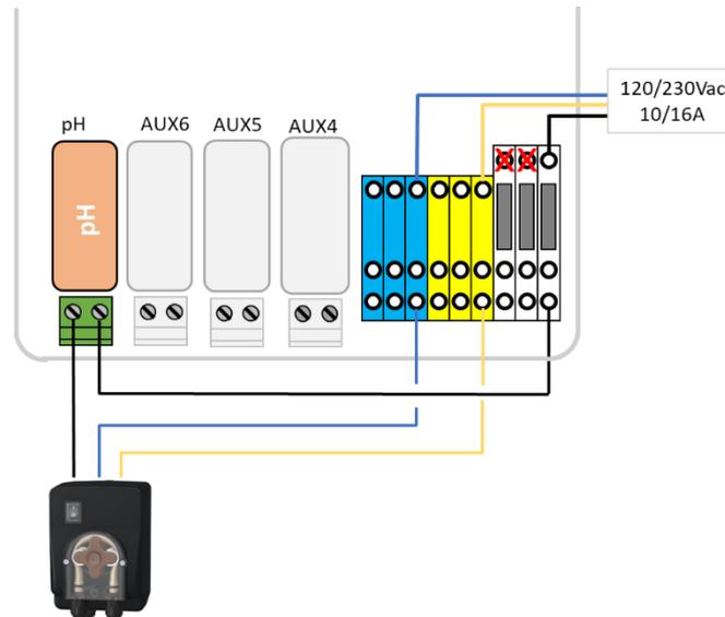
Figura 53 - Conexão direta da bomba dosadora
