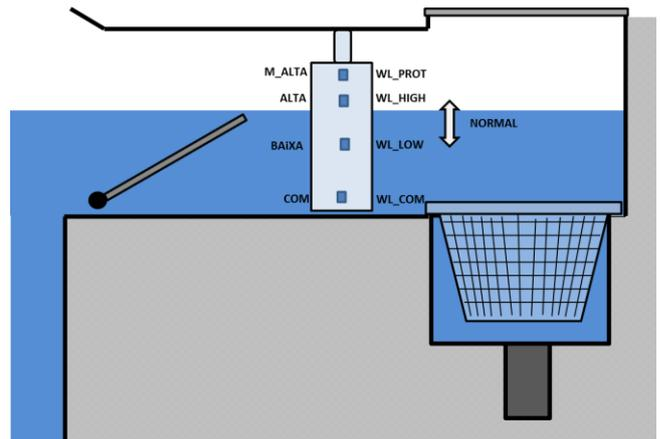
Figura 56 - Sensor de nível de linha de água
