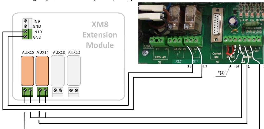
Figura 72 - Exemplo de conexão com a cobertura do Aqua Dec
