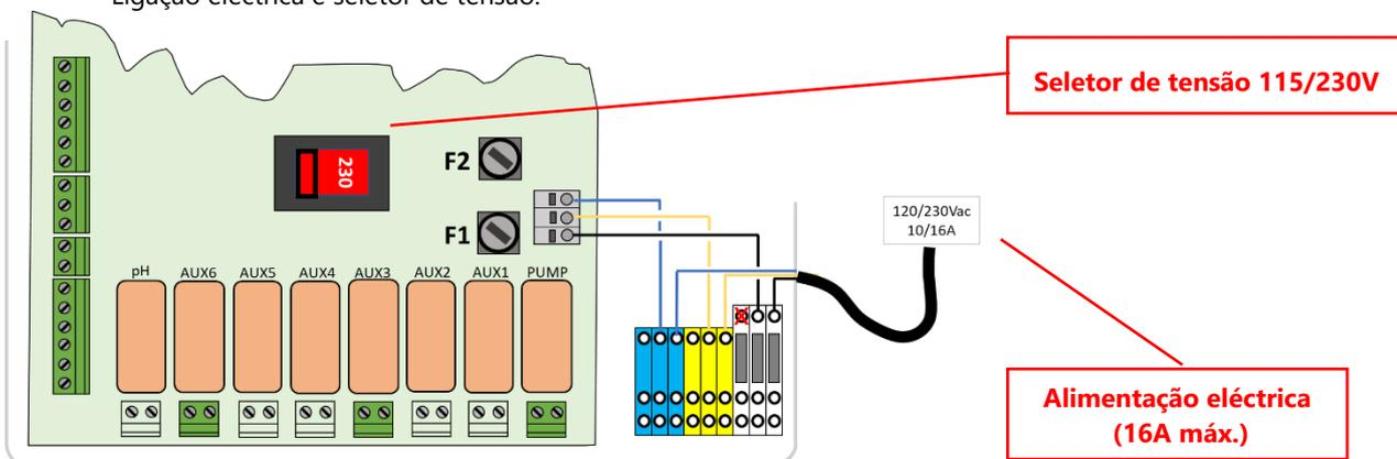
Figura 5 – Ligação eléctrica e seletor de tensão
