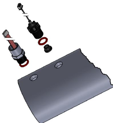
**Figura 29 - Sensores aparafusados na tubulação de 3"**
