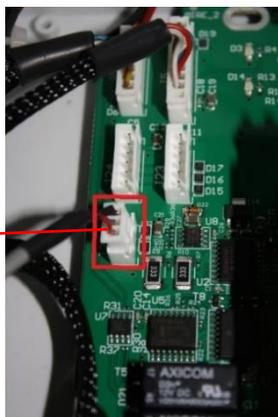
Figura 33 – Sonda de temperatura do ar em J27
