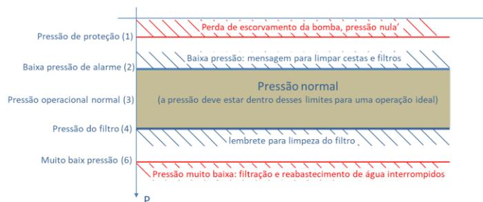
Figura 84 - Parâmetros de ajuste de sucção
