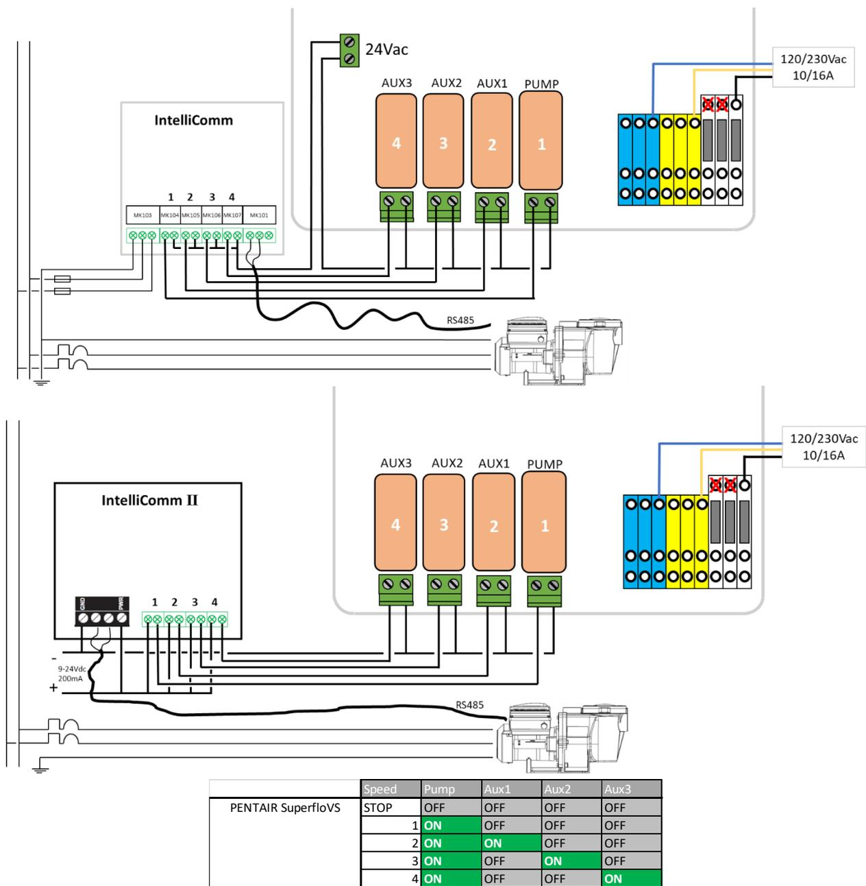
Figura 11 - Pentair IntelliFlo VSD/VSF com IntelliComm ou IntelliComm II
