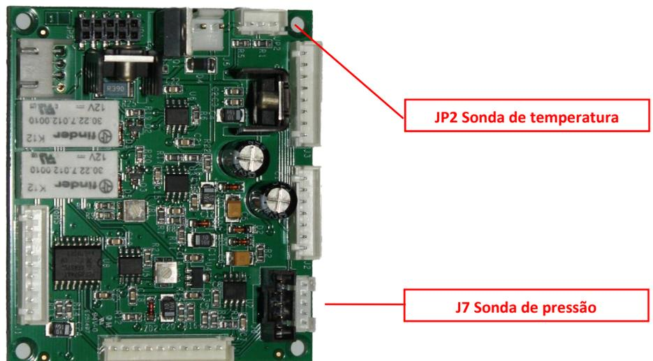
Figura 32 - Conexão das sondas de pressão e temperatura da água
