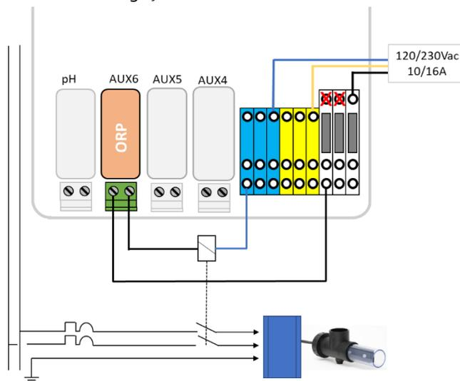
Figura 55 - Ligação do eletrolisador ao sal
