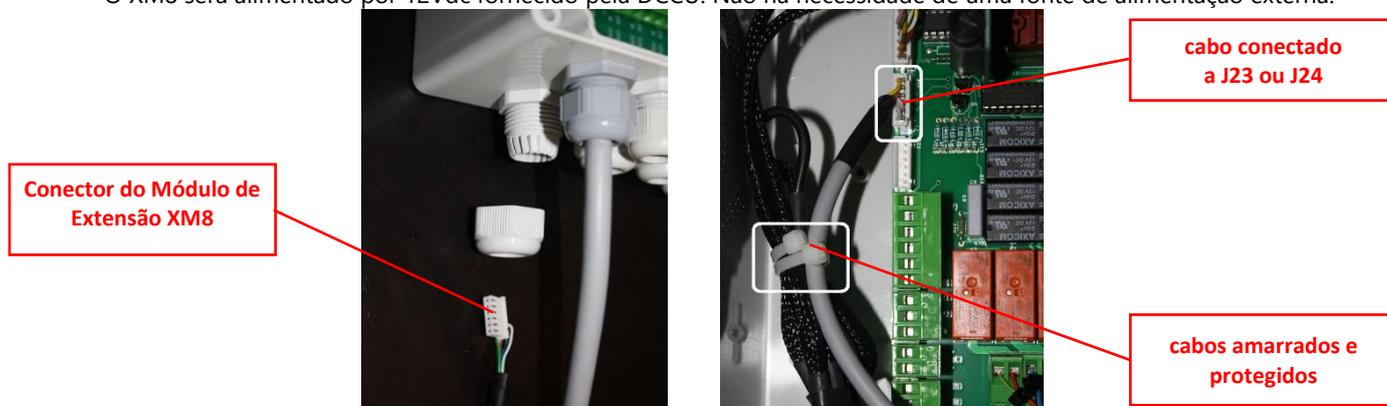
Figura 60 - Entradas de cabos
